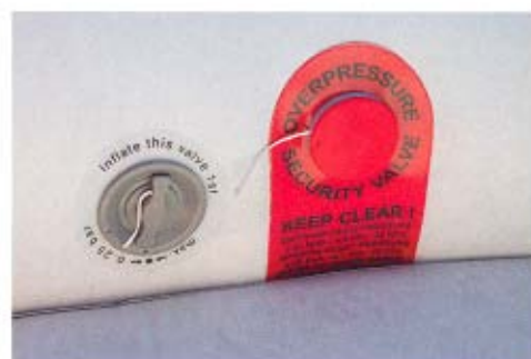
En ventil sikrer mod for høj lufttryk, så her behøver man ikke være bekymret for at pontonerne eksploderer i solen. Det gælder i øvrigt alle Lodestars modeller.
